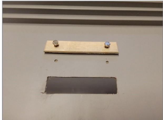
5. Mittig in den Deckel zwei Löcher bohren, Durchmesser jeweils etwas kleiner als Durchmesser der Taschenlampen wählen
